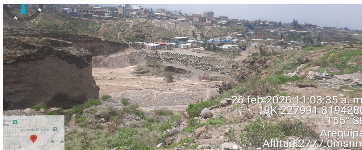
IMAGEN 02: SE MUESTRA LA COLMATACION, Y UNA EXTRACCIÓN DE MATERIAL DE ACARREO EN LA QUEBRADA GAMARRA EN EL SECTOR VILLA CERRILLOS
